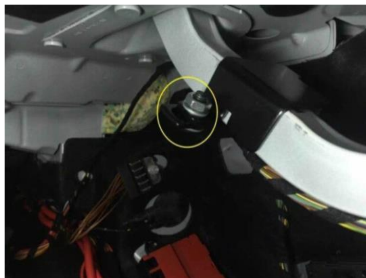
10. Зафиксируйте положение винтами как на рисунке
