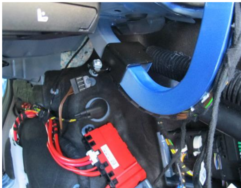
11. Кронштейн крышки после монтажа
