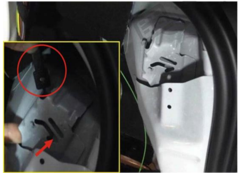
2. Вставьте Т-образный кронштейн из комплекта как указано на рисунке
