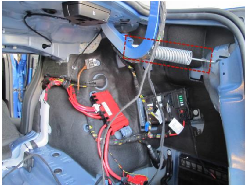
1. Снимите штатные пружины слева и справа
