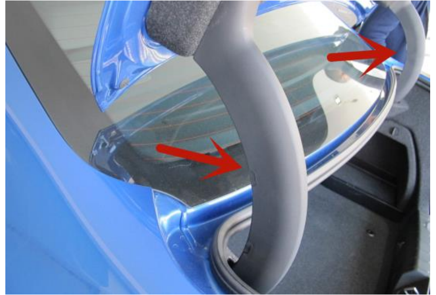
2. Снимите кожухи кронштейнов
