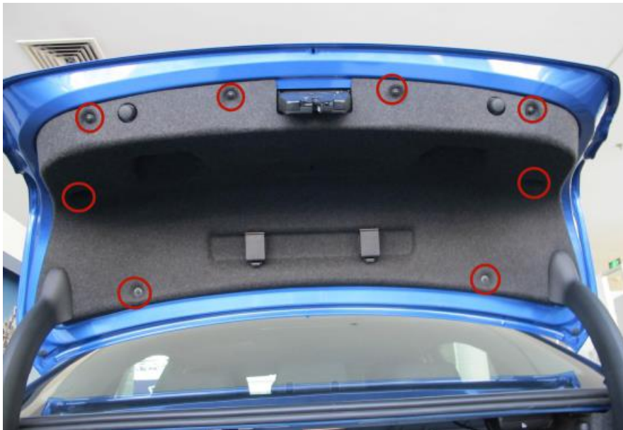
3. Снимите клипсы по периметру и обшивку крышки багажника
