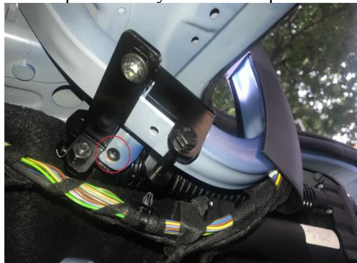
9. Штатное отверстие в красном круге соответствует отверстию кронштейна из комплекта. Зафиксируйте винтом
