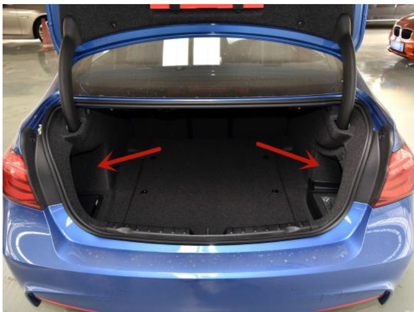
3. Снимите клипсы по периметру и обшивку крышки багажника
