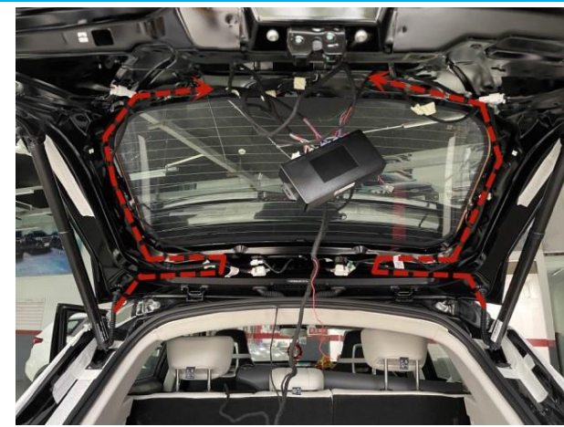
3. Протяните провода в дверь как на рисунке
