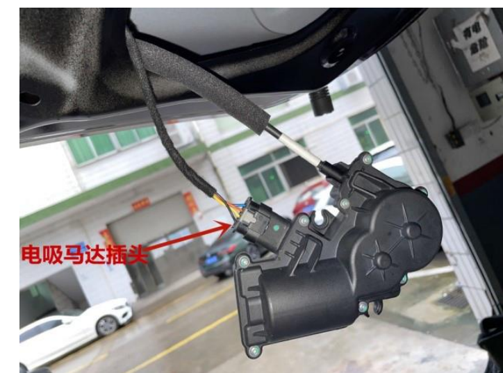
3. Подключите разъем мотора дотяжки
