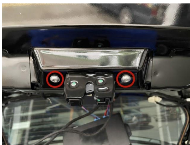
1. Снимите штатный замок и замените на замок из комплекта
