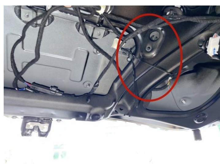
2. Расположите мотор дотяжки как показано на рисунке
