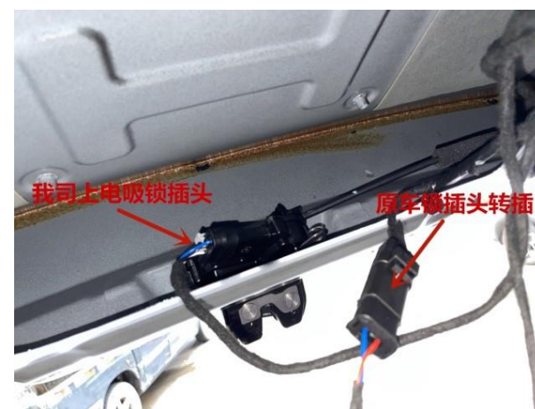
2. Отсоедините штатный разъем замка и подключите через переходник из комплекта
